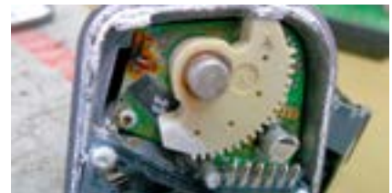
Blick in das Innere einer beschädigten Regelklappe
