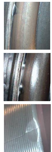
Lagerschäden auf Grund von Einbaufehlern
