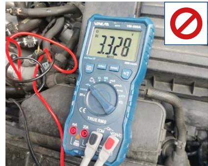
Sollten Sie eine Spannung von ca. 3,3 V messen, ist die Glühkerze für dieses Fahrzeug nicht geeignet.
