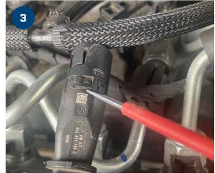
Bauen Sie die vordere Schutzkappe mit einem kleinen Schraubendreher ab.
