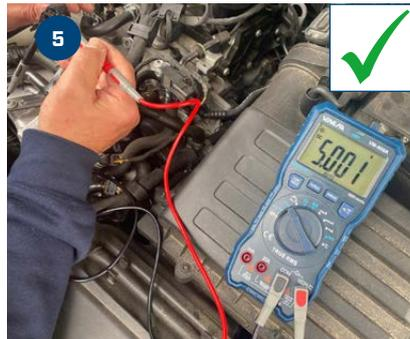
Die angezeigte Spannung muss im Bereich zwischen 4,8 – 5,2 V liegen.
