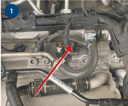
Bei 4-Zylinder VAG Motoren ist die Drucksensor Glühkerze am 3. Zylinder verbaut.
