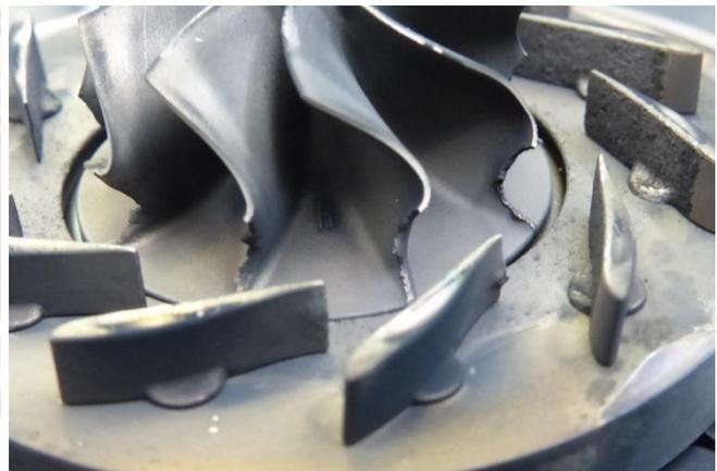
zerstörtes Turbinenrad und VTG-Einheit
