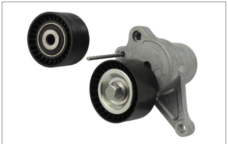
Bild 2: Spann- und Umlenkrolle aus Kunststoff
