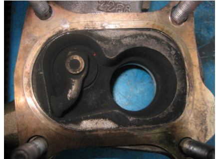
Nesprávně namontované těsnění
