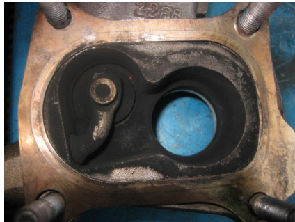
Falsch montierte Dichtung
