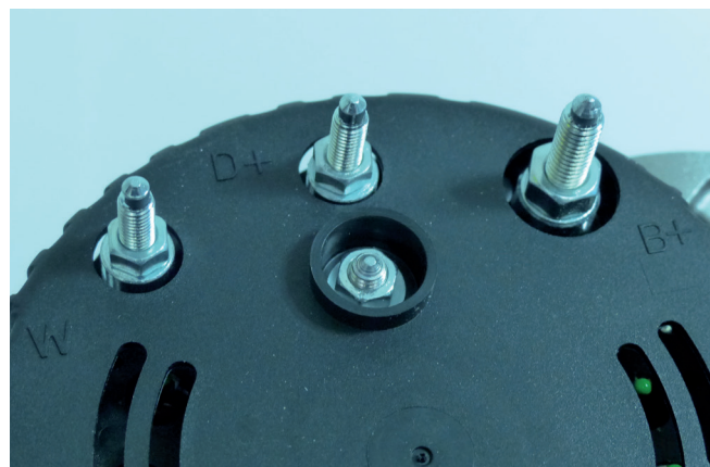
Figure 2 : Désignation des bornes de l'alternateur : W = signal de régime, D+ = témoin de contrôle de charge et B+ = plus de la batterie
