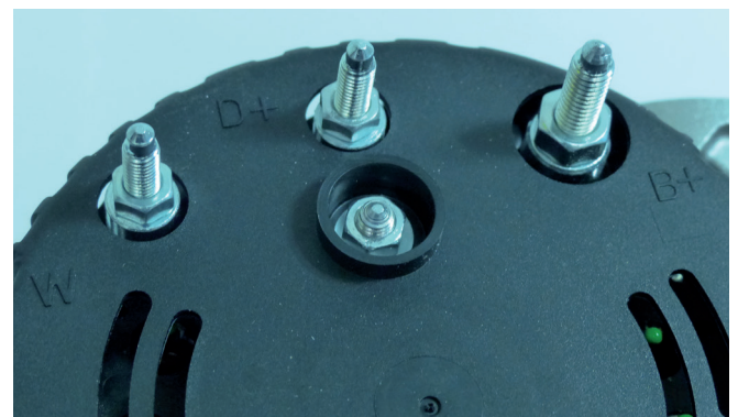
Εικόνα 2: Χαρακτηρισμός ακροδεκτών στη γεννήτρια:
