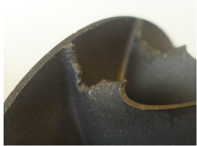
Turbina escape dañada
