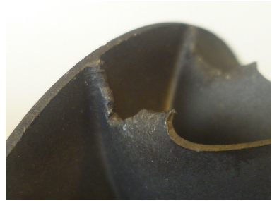
Turbina do escape danificada
