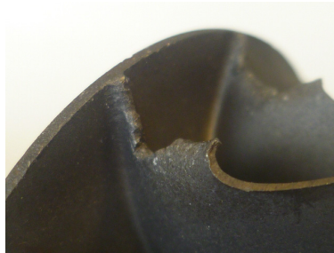
Turbina scarico danneggiata
