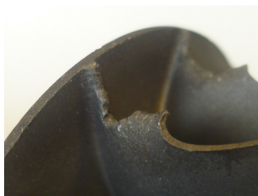
Poškozená výfuková turbína
