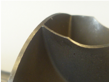
Turbină de evacuare nouă, nedeteriorată
