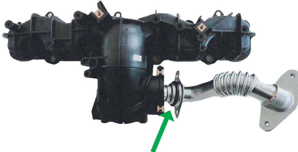
**Dichtring vor dem Austausch des Saugrohrmoduls ersetzen!
