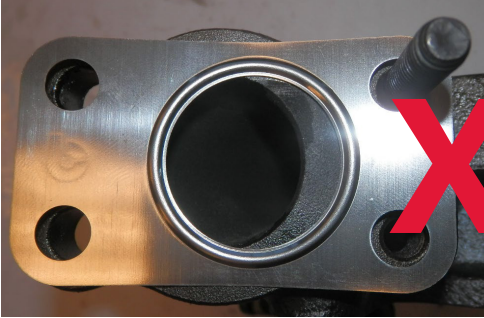
Mise en place incorrecte
